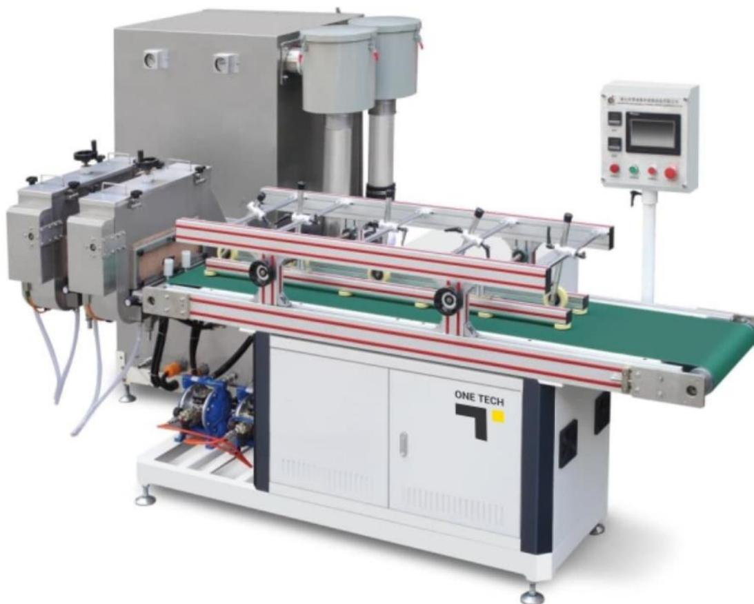
В машине NT-Vac2H-UV используется вакуумная технология для нанесения краски с помощью насоса и форсунок в закрытом контейнере. Краска распыляется форсунками на деталь с высокой скоростью и, благодаря контрпрофилю детали и вакуумному насосу, равномерно покрывает поверхность деталей, отводя излишки материала в циркуляционный контур для повторного нанесения.
